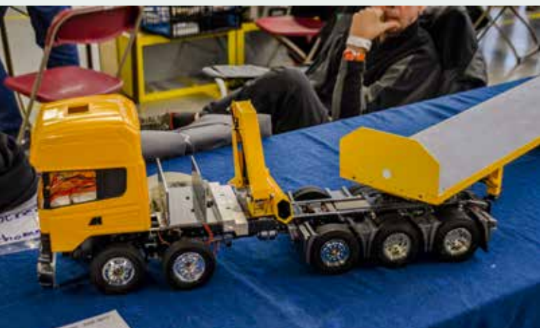
Sonderfahrzeugbau: noch nicht ganz fertiggestellte 5-achsige Zugmaschine mit Ladekranaufbau zwischen der 2. und der 3. Achse.
