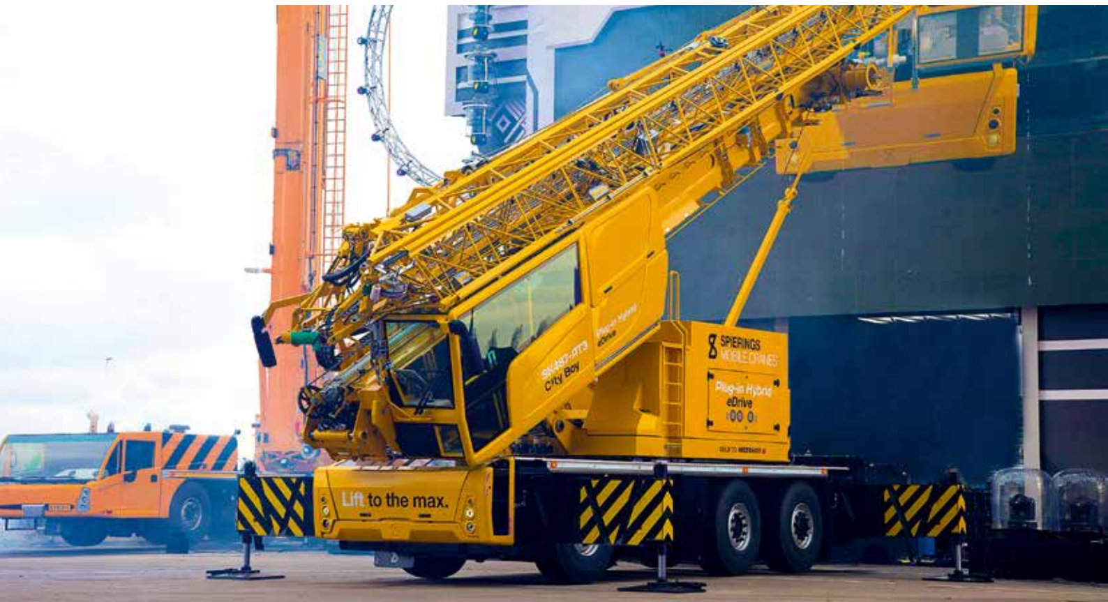
Der „City Boy“ bei seiner Präsentation im vergangenen Jahr. Der 3-achsige Mobilfaltkran ist mit 36 t zulässigem Gesamtgewicht auf der Straße unterwegs und verfügt über einen vollelektrischen Antrieb.
