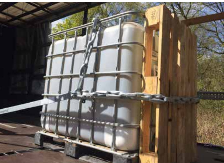
Die PowerLash-Kette wird vollständig aus Gurtband aus Dyneema gefertigt.
