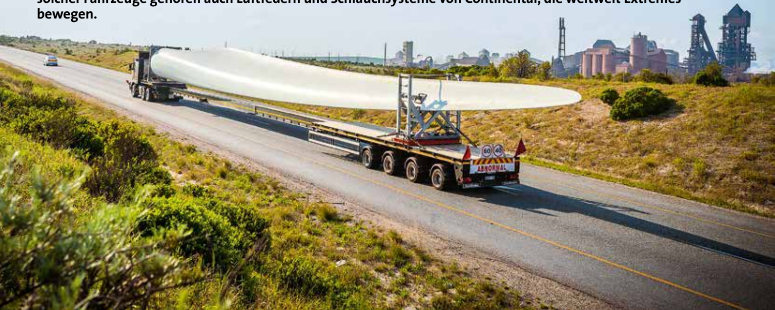
Dieser Goldhofer-Teleaufzieger ist mit Luftfedern von Continental ausgestattet.
