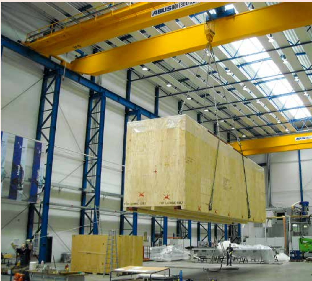
Fertiggestellte Schwergutkiste bereit für den Transport.
