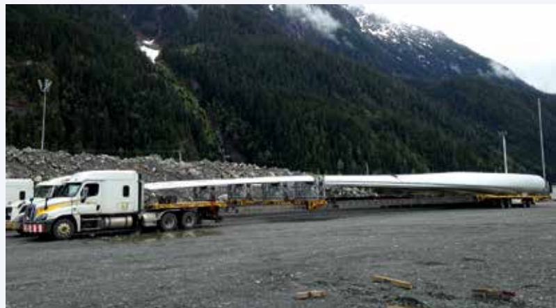
Für den Transport der Windräder durch die Berge Westkanadas kamen Pritschenaufzieger mit Luftfedern von Continental zum Einsatz.
