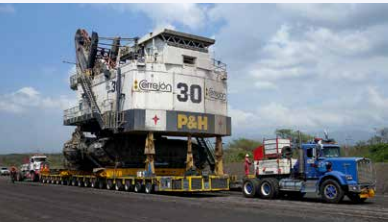
1.200 t wiegt der Schaufelradbagger, der in Kolumbien auf zwei parallel geführten Schwerlastkombinationen verlegt wurde. Jede Kombination besteht aus drei Modulen, die durch Hydraulikkupplungen und Leitungssysteme von Continental miteinander verbunden sind.
