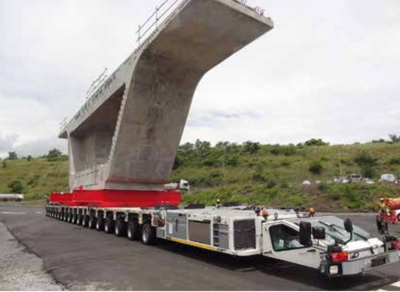
Eine 18-achsige Schwerlastkombination brachte 700 t schwere Brückenpfeiler auf La Réunion ans Ziel.
