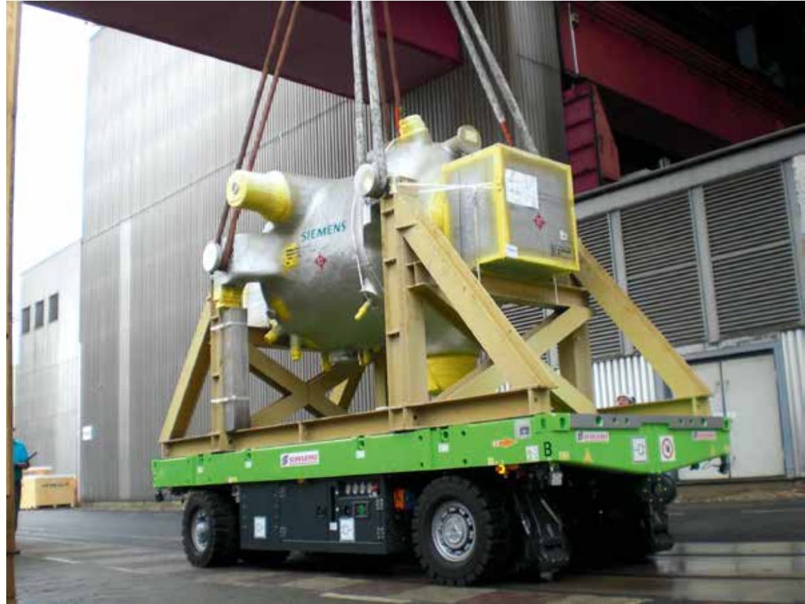
Siemens erprobt die Einbindung des vollelektrischen SPMT Light im Werk Mülheim.
