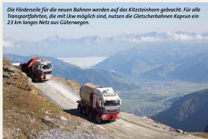
Per Lkw gelangt der Liebherr-Schnelleinsatzkran 53 K durch das hochalpine Gelände hinauf zur Mittelstation auf 2.628 m.
