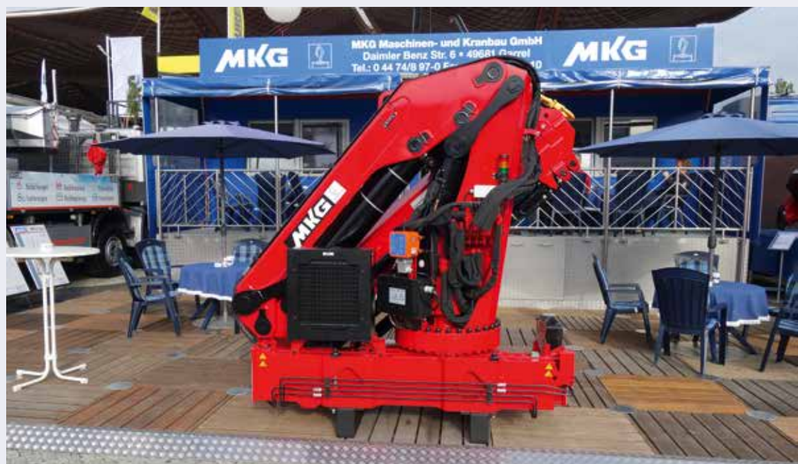
Im Mittelpunkt des Messeauftritts von MKG standen in diesem Jahr die Ausstattungsmöglichkeiten, die das Unternehmen für seine Krane anbietet. So wurde das elektronische Standsicherheitssystem ACS3 durch die Zusatzausrüstung ACS3 Plus erweitert. Sie bezieht das jeweilige Lkw-Eigengewicht in die Berechnung der Standsicherheit mit ein und berücksichtigt beispielsweise, dass ein beladenes Fahrzeug oder eine aufgesattelte Zugmaschine bei gleicher Abstützweite eine höhere Standsicherheit aufweist, als eine Solo-Sattelzugmaschine oder ein leeres Fahrzeug. ACS3 Plus erkennt diese Zustände und gibt entsprechend mehr Hubkraft frei, oder gleiche Hubkraft bei geringerer Abstützweite. KM-Bild
