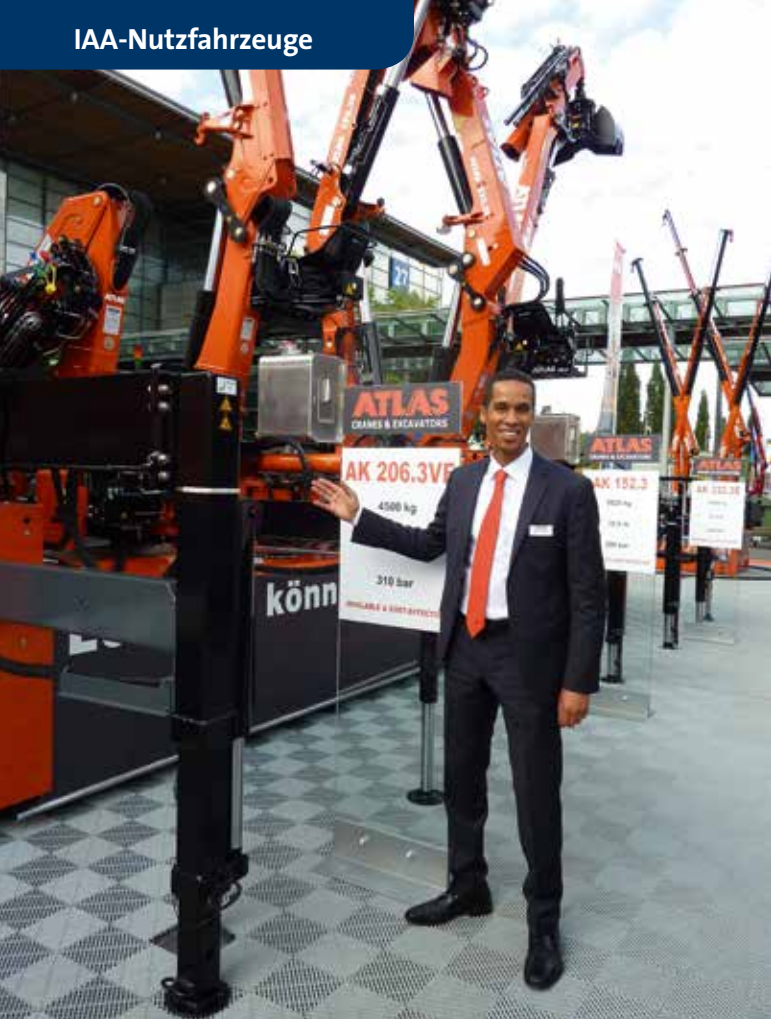
Brahim Stitou, Geschäftsführer Atlas Maschinen GmbH, freute sich über den gelungenen Auftritt seines Unternehmens in Hannover. Premiere feierte der Atlas 152.3, der sowohl als V- wie auch als Langarmkran erhältlich ist. Der Atlas 152.3 V A12 liegt in der Größenklasse bei 154 kNm, die Reichweite beträgt etwa 10,8 m und er bietet eine Traglast von 1.300 kg. Gezeigt wurde neben weiteren Modellen auch der AK 66.3 E mit Faltautomatik, dies es ermöglicht, den Kran mittels „Knopfdruck“ über die HBC-Funkfernsteuerung automatisch zusammen- beziehungsweise auseinander zu falten. KM-Bild
