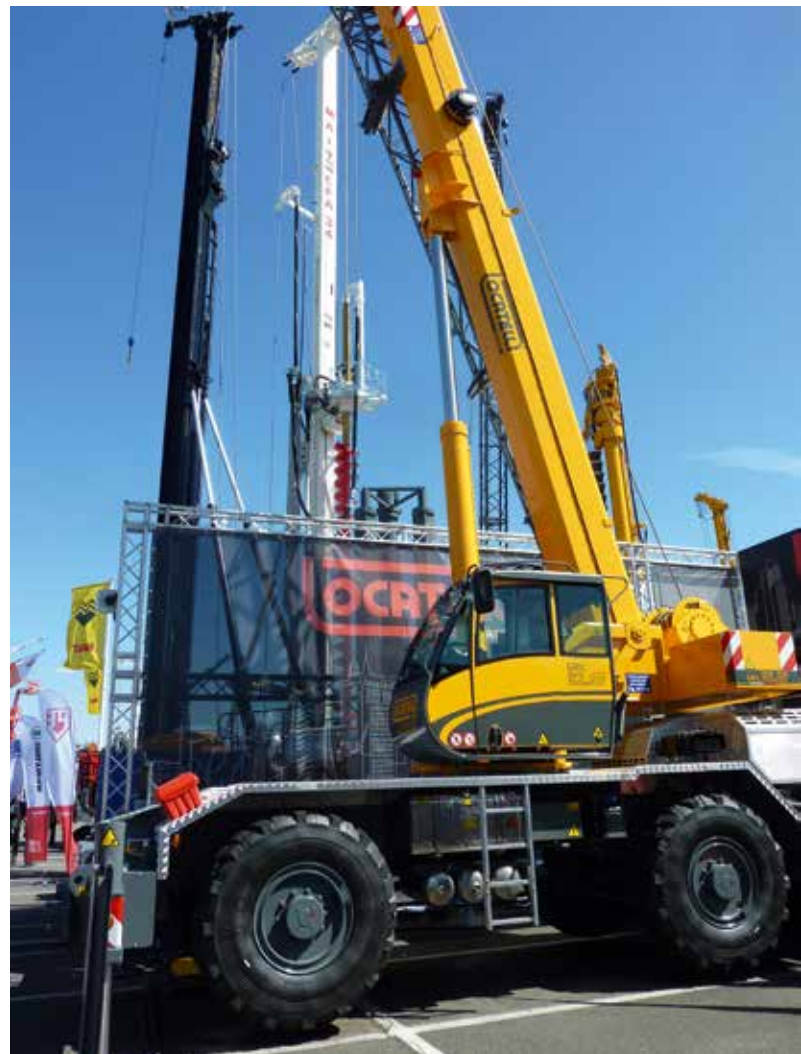
Locattelli präsentierte auf der Intermat den neuen GR12.47. Der Geländekran bietet 52 t maximale Tragfähigkeit und einen 32 m langen Ausleger.
