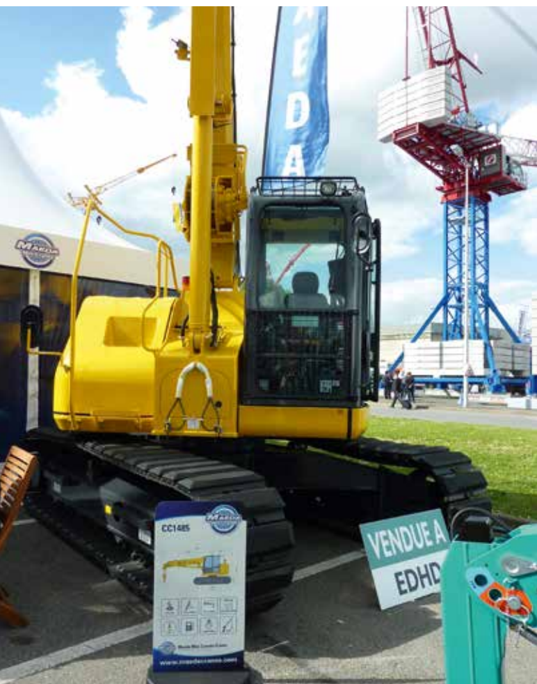
Maeda Mini Cranes, die in Deutschland von Uplifter vertrieben werden, präsentierte Raupenkran-Lösungen in unterschiedlichen Größen und Tragfähigkeitsklassen. Mit dabei der CC 1485, der bis zu 6.000 kg Tragkraft und eine Hubhöhe von bis zu 16,70 m bietet – optional verlängerbar auf 22 m. Der dieselgetriebene Kran kann mit Lasten von bis zu 2.000 kg verfahren. Eine Rückfahrkamera gehört zur Serienausstattung.
