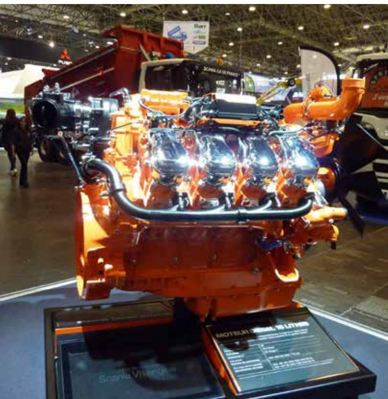
Scania zeigte unter anderem seinen aktuellen V8-Motor, der jetzt schon die EU-Stufe V erfüllt.
