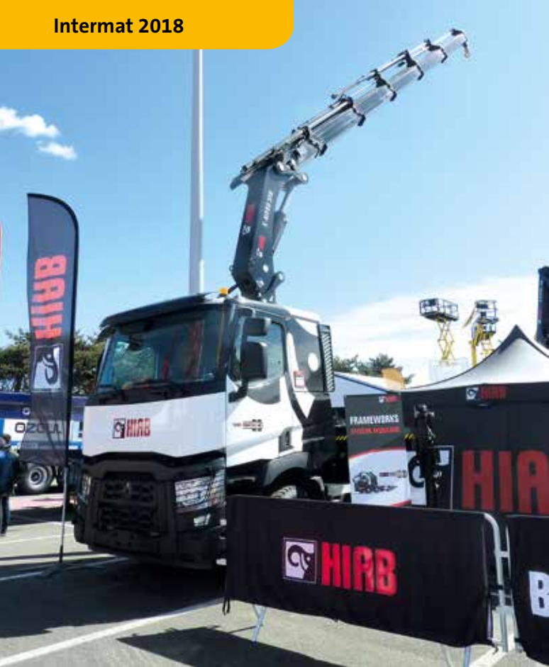
Das modulare System „Hiab Frameworks“ soll die Aufbauzeiten laut Hiab um bis zu 75 % verkürzen. Das System bietet einen vorgefertigten und installationsbereiten Rahmen, der perfekt an den gewählten Lkw angepasst sein soll. Hier fiel die Wahl auf einen Renault Lkw, auf den ein Hiab X-HiPro 558 aufgebaut wurde.
