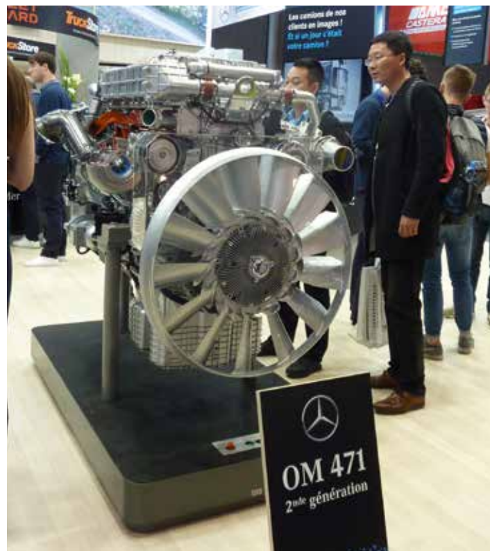
In Paris zeigte Mercedes Benz France auch den neuen OM 471. Der OM 471 der 2. Generation soll im Vergleich zum Vorgängermotor bis zu 3 % Kraftstoff einsparen.
