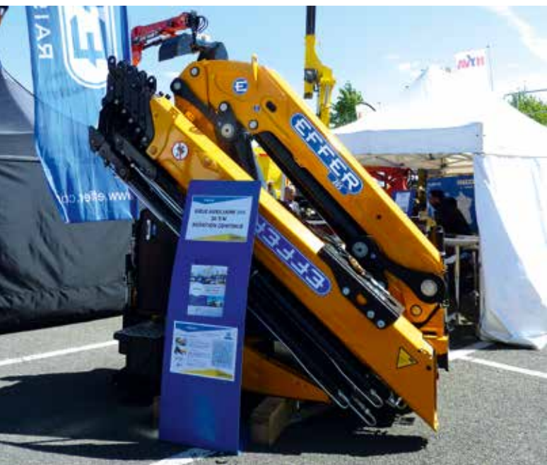
Von Effer gab es unter anderem den 205 zu sehen: ein Kran der 20 mt-Klasse, der eine maximale hydraulische Reichweite von 16,91 m bietet und für den zusätzlich noch verschiedene Jibs bereit stehen. Der Kran kann darüber hinaus mit Standardausleger oder kurzem Ausleger zum Einsatz kommen.
