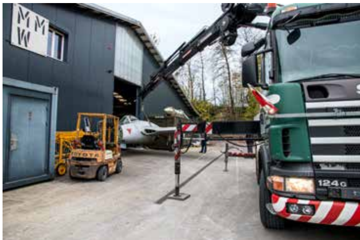
Bis der Flügel vorne und hinten ansteht, kann man mit dem Kran seitlich schieben.
