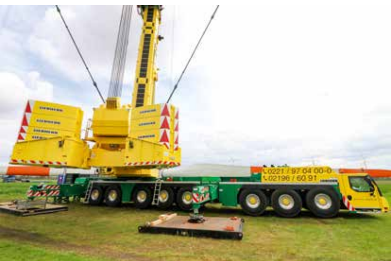
Eingesetzt war der Kran in T3YV2EN Konfiguration: 45 m Hauptmast, 12 m Teilverlängerung, 49 m Wippe und 105 t Ballast im Radius 8,4 m.
