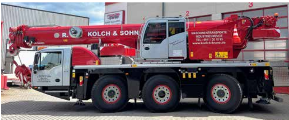
Der AC 3.055-1 mit 50 Meter Ausleger und Verfahrbarkeit mit vollen Gegengewicht von sechs Tonnen.
