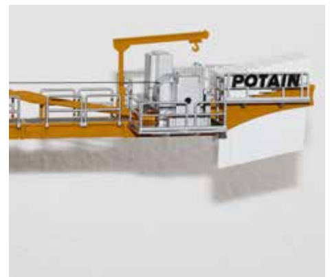
Modell des Potain MDT809 im Detail mit Kranführerkabine, Treppen im Turm und Laufblechen auf dem Ausleger, Gegenausleger, Seilwinde und Gegenballast.
