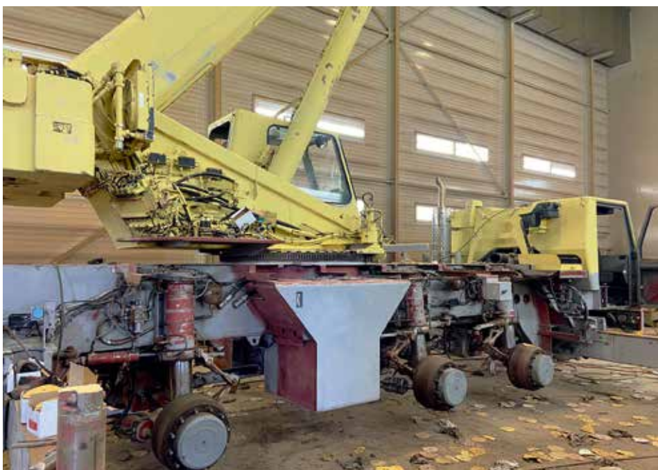
Der Grove GMK3050 wird in alle Einzelteile zerlegt und überarbeitet.
