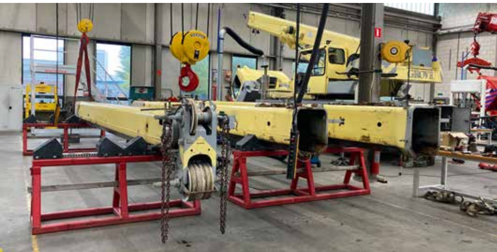
Wichtige Komponenten, darunter der Ausleger und die Winde wurden einer fachmännischen Überholung unterzogen.
