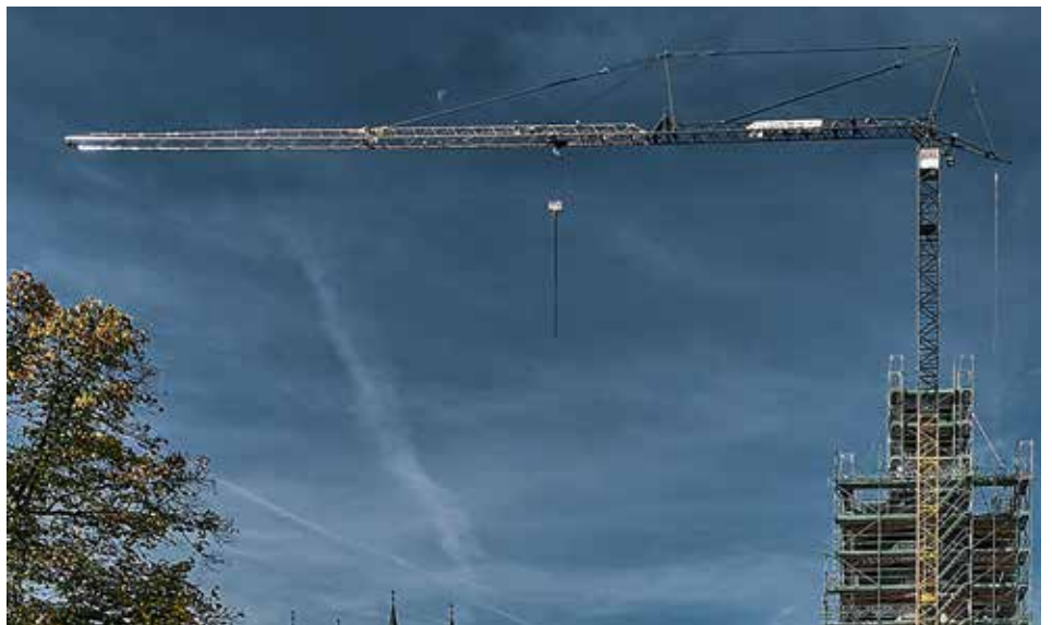
Der 81 K.1 bietet eine maximale Traglast von sechs Tonnen und eine Spitzentraglast von 1.350 Kilogramm bei einem 48 Meter langen Ausleger.
