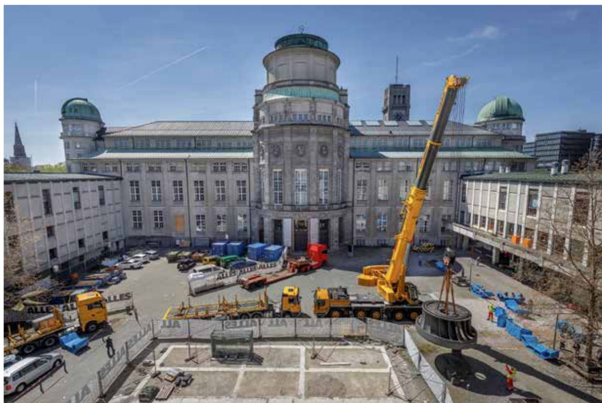
Der LTM 1250-5.1 der Firma Kran-Maier hebt ein 44 Tonnen schweres Lauftrad aus dem Innenhof des Deutschen Museums in München.
