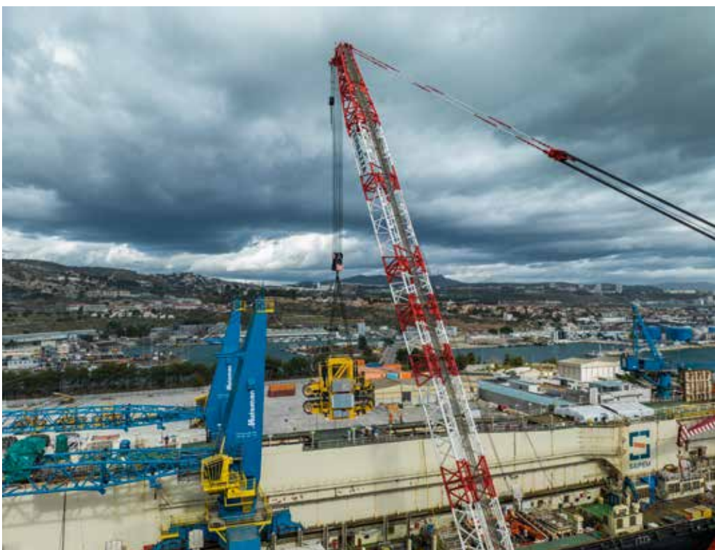
Der CC 68.1250-1 hebt moderne Komponenten auf das Verlegeschiff CastorOne von Saipem.
