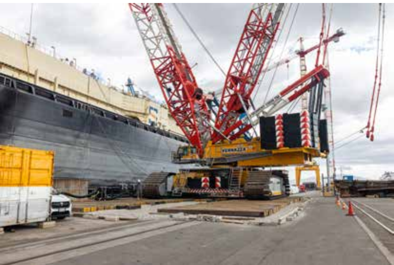
Da der Kettenabstand der Tadano-Raupe beinahe der Schienenbreite des Hafenkran auf dem Kai entsprach, konnte der CC 68.1250-1 auf ausgelegten Kranmatten problemlos verfahren werden.
