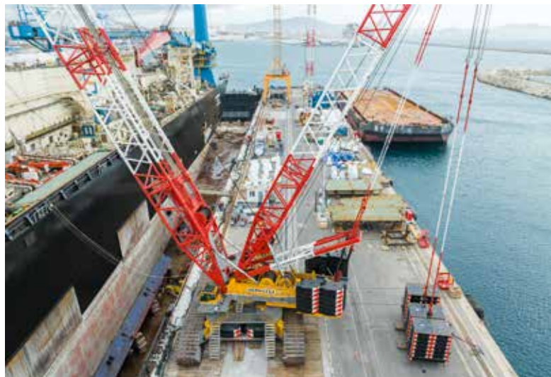
Da der Kettenabstand der Tadano-Raupe beinahe der Schienenbreite des Hafenkran auf dem Kai entsprach, konnte der CC 68.1250-1 auf ausgelegten Kranmatten problemlos verfahren werden.
