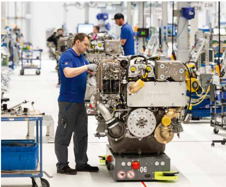
Im neuen Rolls-Royce Werk in Kluftern werden mtu-Motoren der bewährten Baureihe 2000 produziert, die weltweit als Antriebs- und Energiesysteme für Yachten, Fähren, Schlepper, Windfarmversorgungsschiffe, Bergbaufahrzeuge und Notstromaggregate eingesetzt werden.
