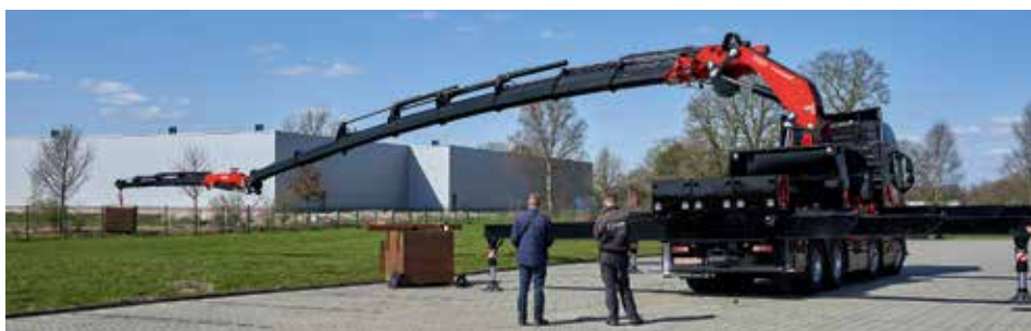
Die Ausschübe des Auslegers mit dekadonalem Querschnitt sorgen für Verwindungssteifheit
