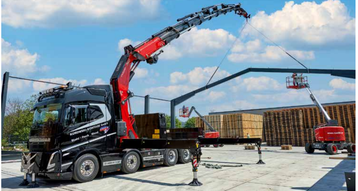
Die doppelte Frontabstützung erlaubt mehr als 80 % der max. Hubkraft auch über der Fahrerkabine.
