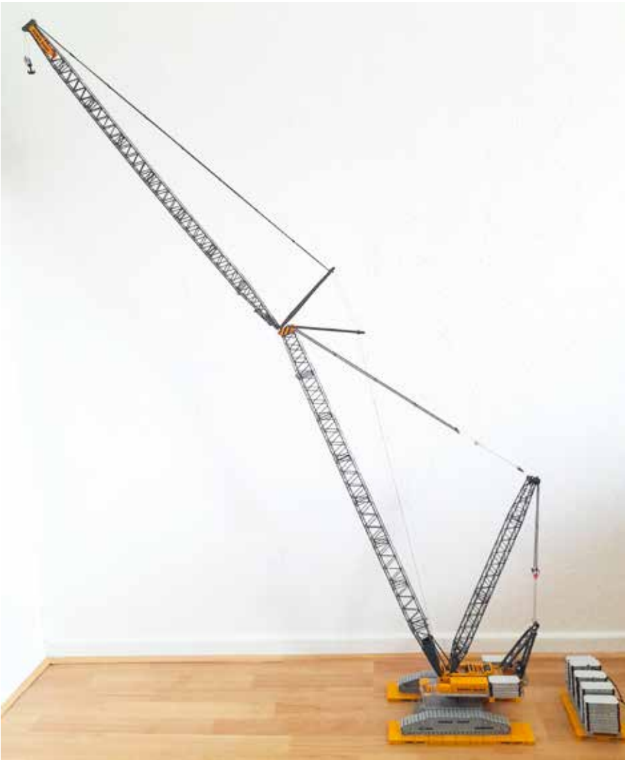
175 cm Hakenhöhe, 80 cm Ausladung mit Metall-Gittermasten, nur mit Drehbühnenballast, ohne Schwebeballast.
