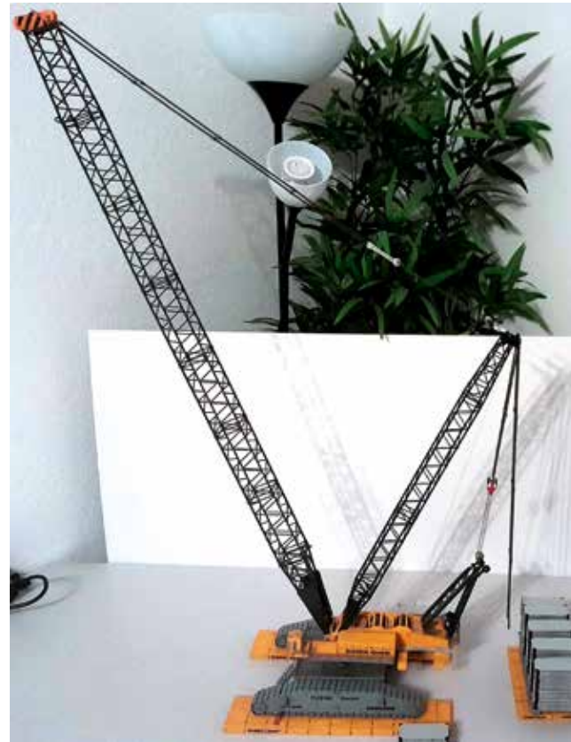
Rüstzustand schwerer Metall-Hauptausleger, Derrick Ausleger. Der Kran steht sicher ohne jeglichen Ballast.
