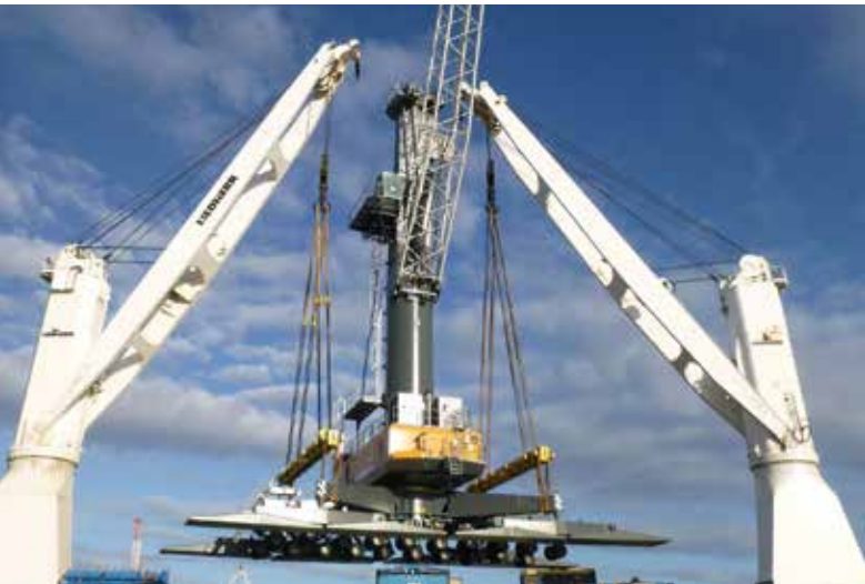
Per Tandemhub wurden die Hafemobilkrane von zwei Liebherr Schiffskranen vom Typ CBB 4200-350 entladen.
