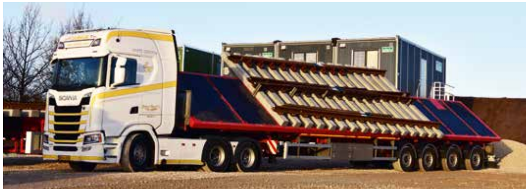
Auf Schrägladefliegern angelieferte Gleiselemente.
