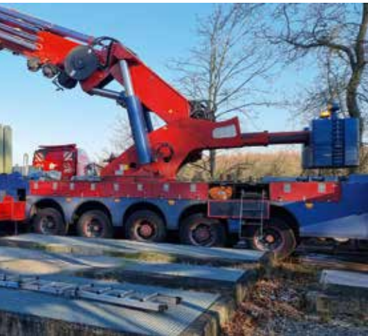
Einhub der Elemente per Tandemhub.
