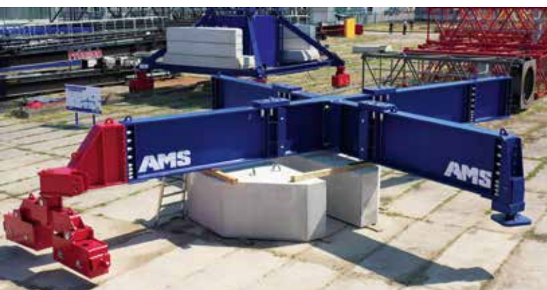
Modulares Kreuz mit Schienenfahrwerk, Spindelfuß und Verlängerung.
