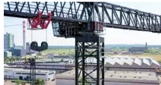
AK 810 Detail, Kranfahrerkabine, Laufkatze und Hakenflasche.
