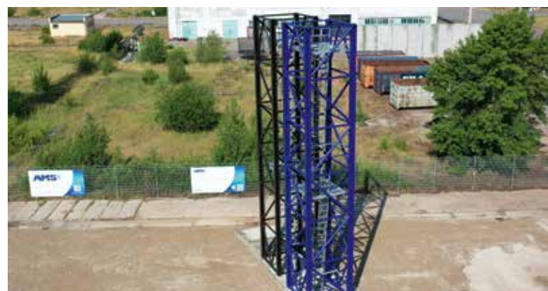
12 Meter langen Turmelementen M26/26 mit ca. 2,90 Metern Transportabmessung.
