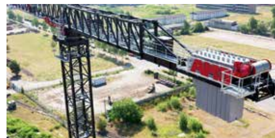
AK 810 mit experimentellem Akkupack zur Energierückgewinnung.
