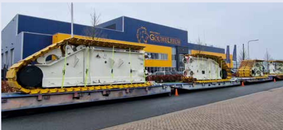
Angeliefert zum Lackieren: das Kettenfahrwerk der CC8800-1.
