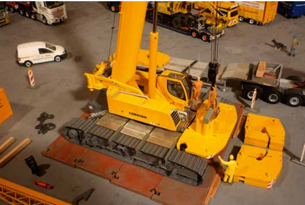
Das Modell bei der Selbstmontage, hier: die Ballastierung.
