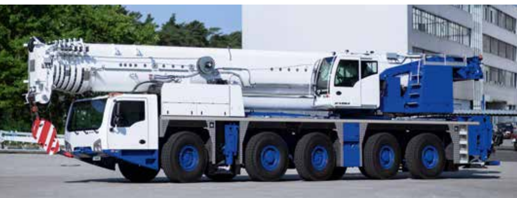
TailGUARD stoppt den Kran bei Rückwärtsfahrt, wenn eine Kollision droht.
