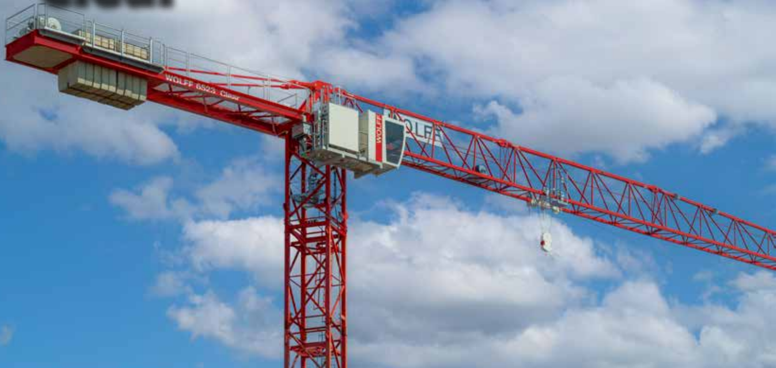
Der neue WOLFF 6523 Clear. An der Unterflasche erkennt man in Rot die Akkubox des Systems.
