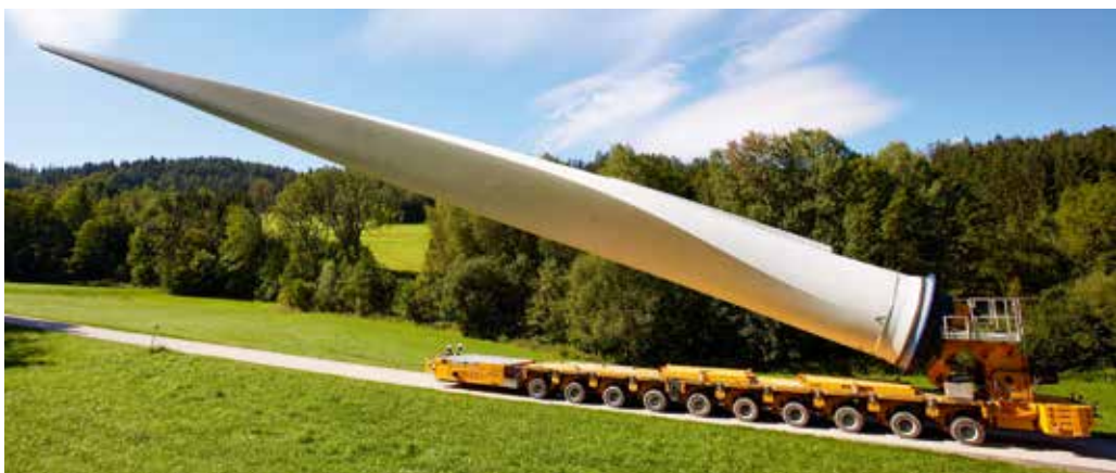
10 Achs-Selbstfahrer mit Flügelvorrichtung transportiert WKA-Flügel ins Gebirge.
