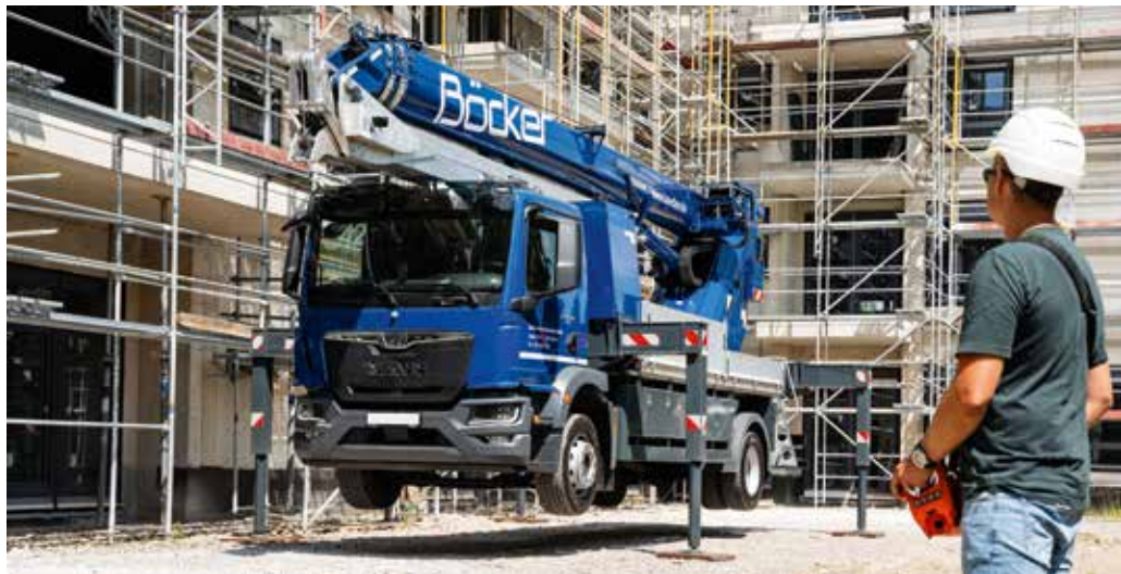
Der große Stützenhub von 85 cm gleicht Bodenebenheiten souverän aus.
