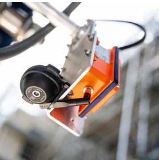
Über die Hakenkamera hat der Bediener stets die Situation auf dem Dach im Blick.
