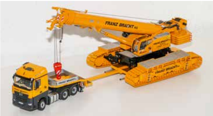
Das Umsetzen des kompletten Teleskopausleger-Raupenkran mit dem ausziehbaren Auflieger.
