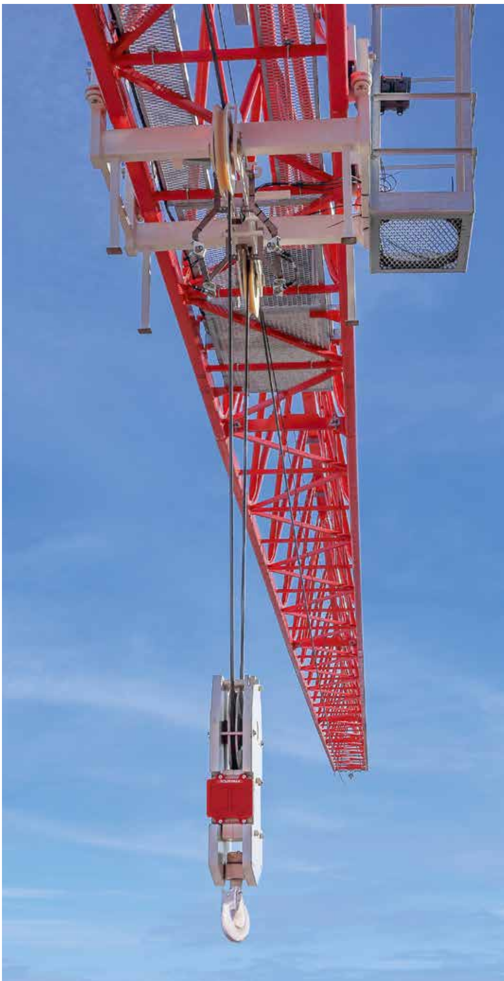
Sensoren an Laufkatze und Hakenflasche machen es möglich: das HiSPS von Wolff.
