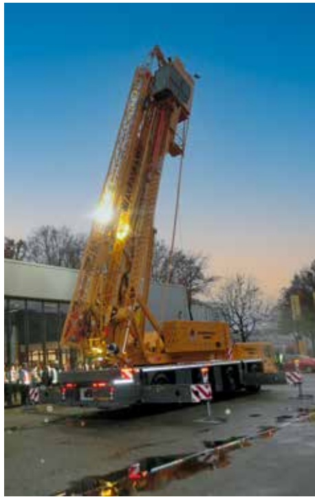
Live-Vorführung des ferngesteuerten Aufbaus des SK597-AT4 eLift.
