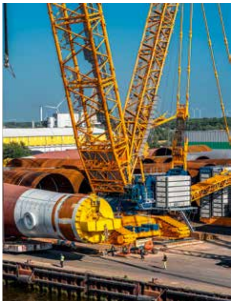
Die Kräfte werden über den 7,5 m breiten High-Performance-Boom in voller Breite in die Drehbühne eingeleitet.
