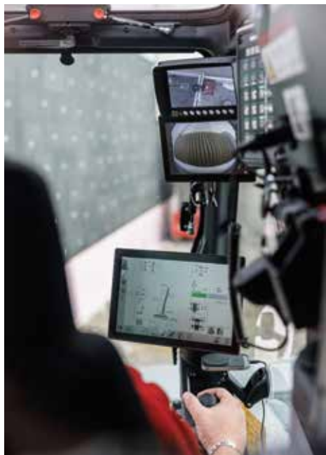
Alles im Blick: LICCON3-Display mit Touch-Funktion.
