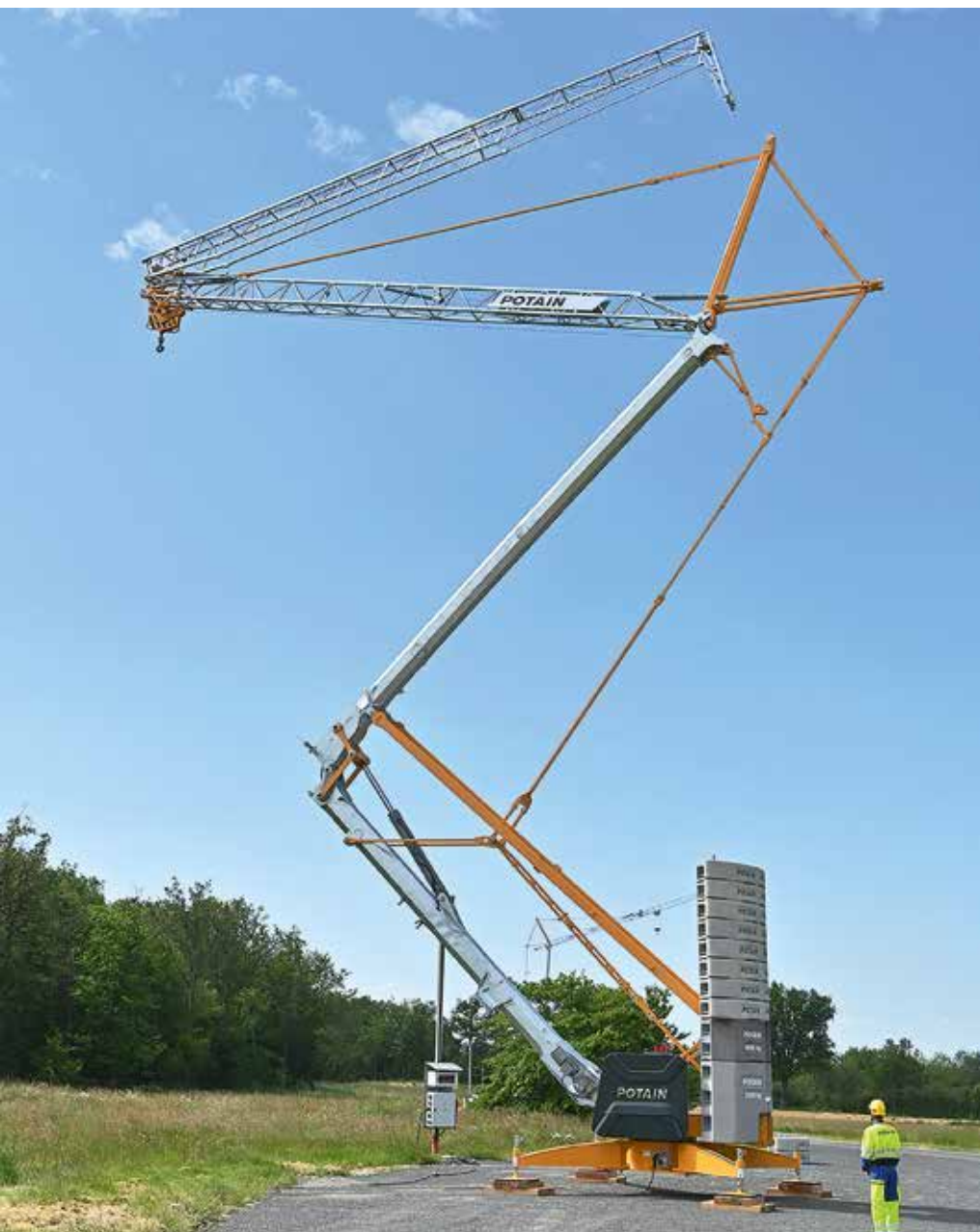
So entfaltet sich der erste Potain-Selbstmontagekran.
