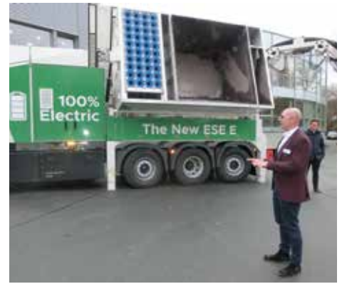
Stephan Prüfer vor dem batteriebetriebenen Saugbagger von RSP.
