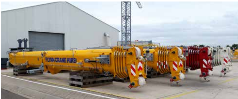
Fertige Teleskopausleger im Außengelände des Tadano-Werks Wallerscheid.
