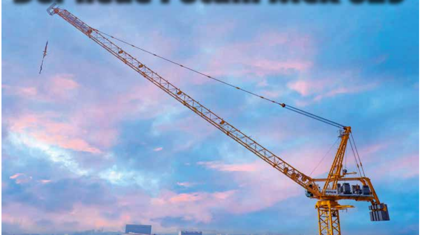
Der neue Potain MCR 625, Turmdrehkran mit bis zu 65m langem Wippausleger.
