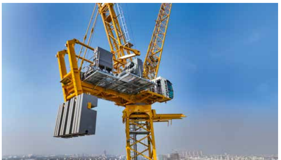
Ein Hauptmerkmal des Potain MCR 625 sind seine beweglichen Gegengewichte.
