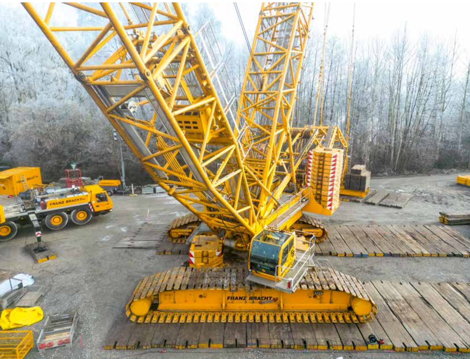
Die Raupe war für den Einsatz mit 50 Tonnen Zentralballast, 225 Tonnen Oberwagen- und 2x 245 Tonnen Superliftballast gerüstet.
