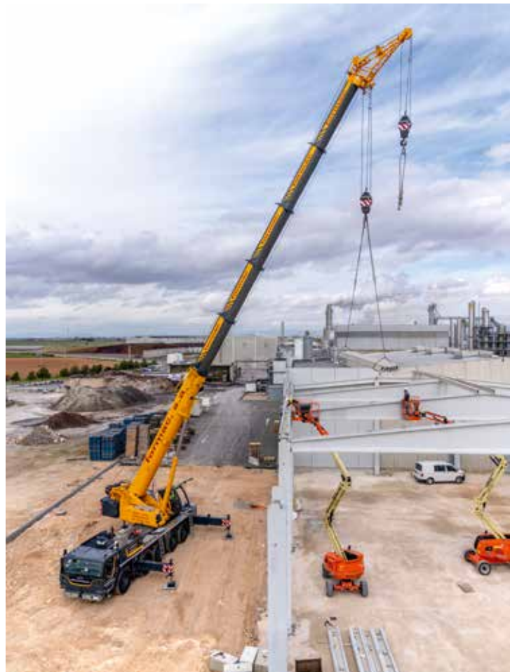
LTM 1119-5.2 mit Montagespitze und zwei Hakenflaschen.
