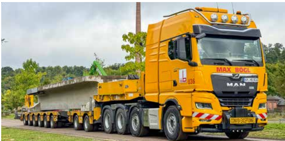
Auch die Fahrbahnelemente der Magnetschwebebahn wurden aus Bayern antransportiert.
