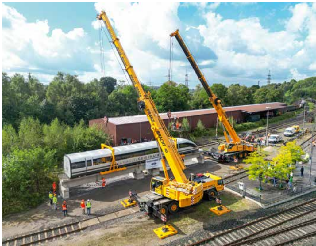
Ein LTM 1130-5.1 und ein LTM 1200-5.1 von Bracht heben den Transrapid 07.
