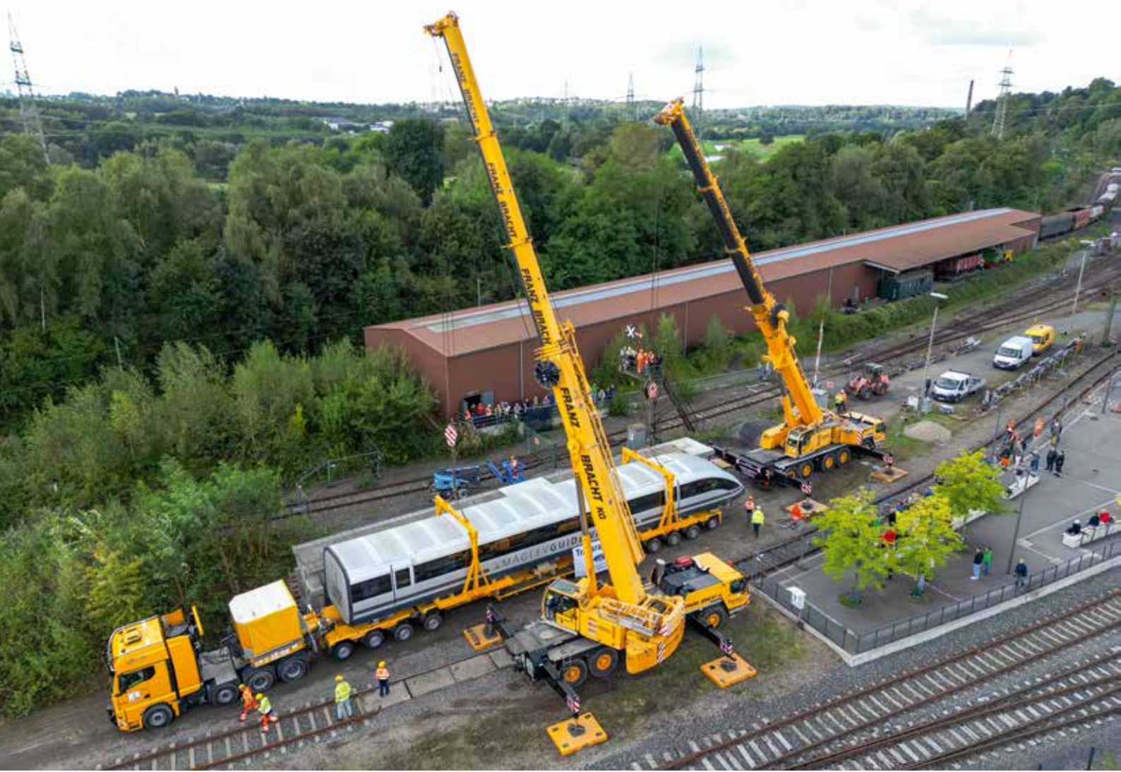
Ein LTM 1130-5.1 und ein LTM 1200-5.1 von Bracht heben den Transrapid 07.
