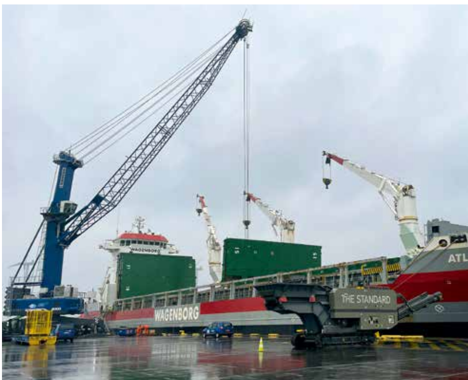
Liebherr-Hafenmobilkran LHM 550 hebt Projektladung am Terminal Zeebrugge.
