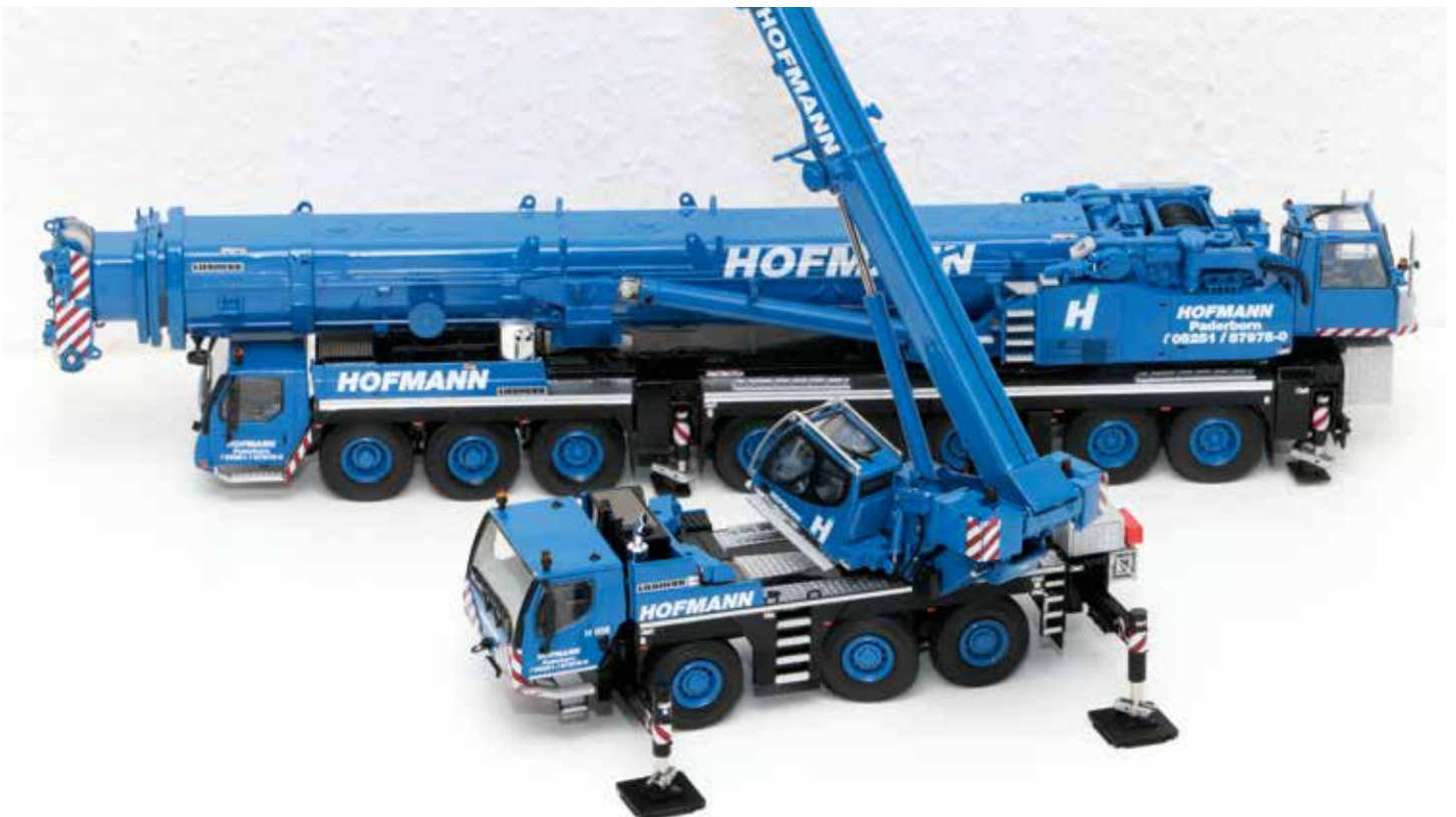
... mit geschwenktem Oberwagen und zusätzlich geneigter Kranfahrrkabine.
