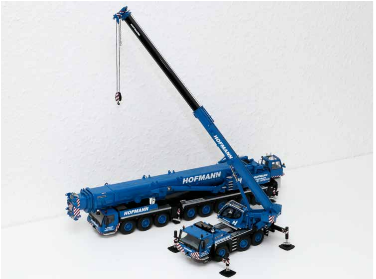
Der LTM 1500-8.1 in Fahrtstellung und der LTM 1050-3.1 in Arbeitsstellung ...
