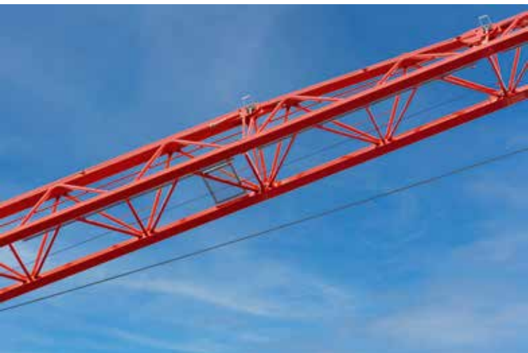
Bild oben: Der WOLFF 8038 Clear mit neuer Obergurtverbindung mit Stecksystem.
