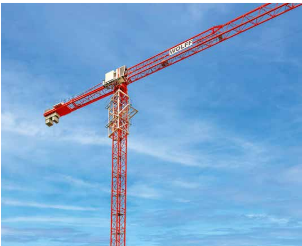
Der WOLFF 8038 Clear vereint die Leistungsfähigkeit eines Turmspitzenkrans mit den Montagevorteilen der spitzenlosen Bauweise.
