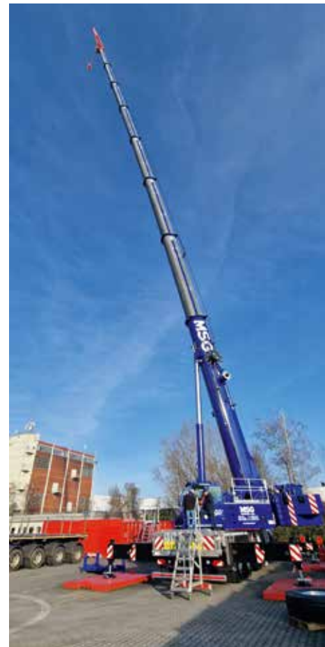
GMK 5250XL-1: voll austeleskopiert mit integrierter Schwerlastspitze.
