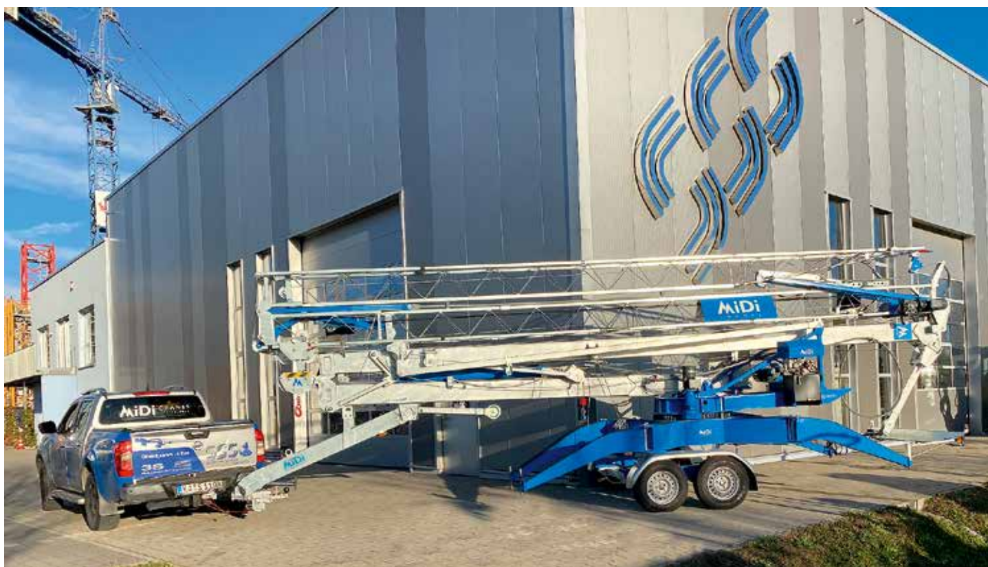
Das größte MiDi-Modell, der LS 15.17A mit einer max. Traglast von 1,5 t.
