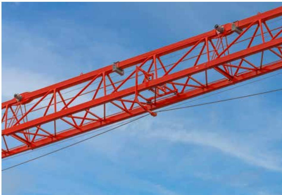
Durch die Konstruktion der ersten drei Auslegerteile als Vier-Gurt- statt als Drei-Gurt-Variante können deutlich höhere Traglasten erreicht werden. Die Hubseilunterstützung am Ausleger reduziert den Seildurchhang von sieben auf nur noch 1,5 Meter und macht das Arbeiten mit mehreren Kranen sicherer.
