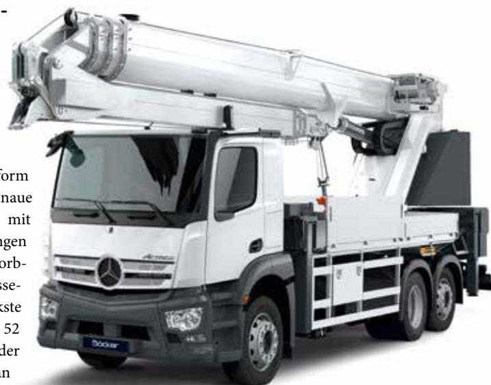
Das Beste aus zwei Welten: Der Elektroantrieb des AHK 48e arbeitet unabhängig vom Dieselmotor des LKWs.
