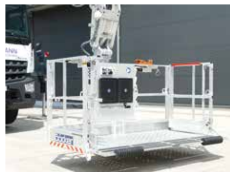
Die vordere Längsseite des neuen Personenkorbs PK 350-DO kann komplett geöffnet werden.
