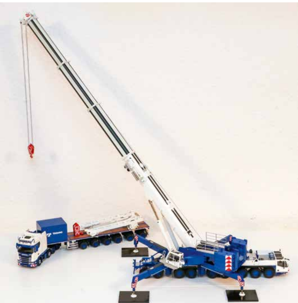
Einsatzbereit: Diagonal abgestützt und mit austeleskopiertem Hauptausleger.
