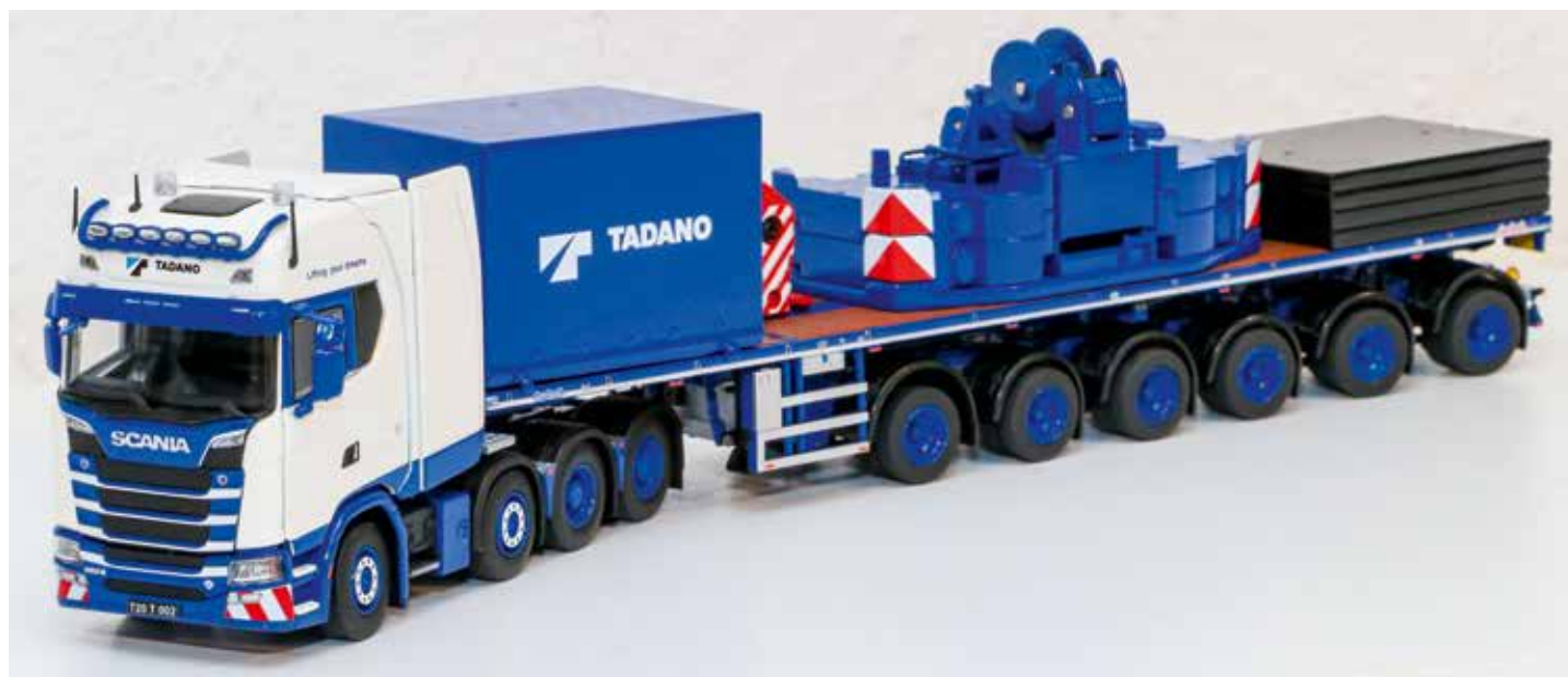
Scania CS20H 8X4 mit Noteboom-Trailer, beladen mit Ballast, Abstützplatten und dem Zubehör-Container.
