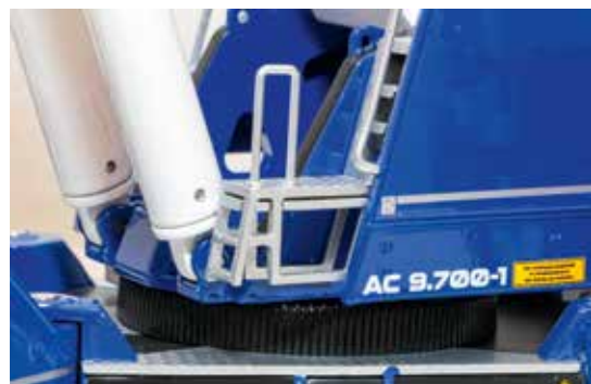
Drehkranz, Typenbezeichnung und Warnhinweise am Oberwagen.
