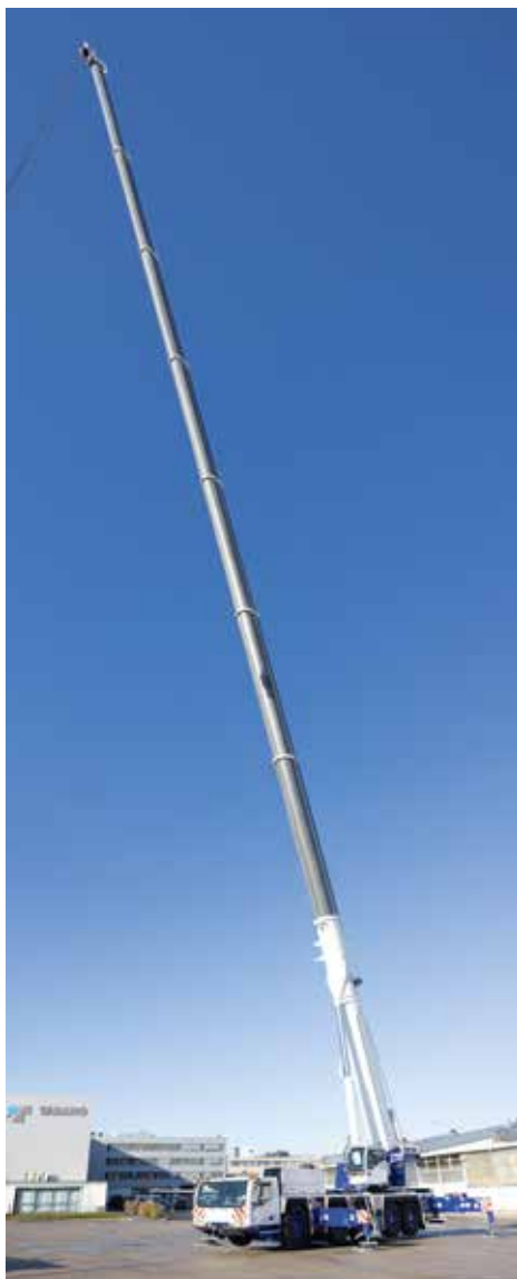
Mit auf 79 Meter voll austeleskopiertem Hauptausleger.
