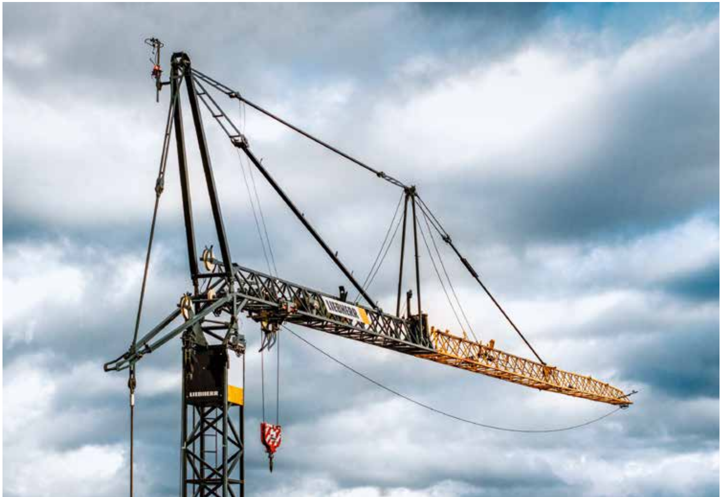
Auch der 61 K erreicht höhere Leistungswerte als sein Vorgänger: Drei Meter zusätzliche Ausladung, eine um 2,4 Meter höhere maximale Hakenhöhe und bis zu 200 Kilogramm mehr Spitzentraglast.
