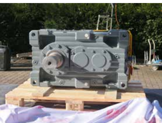
Das innerhalb von 24 Stunden instandgesetzte Stirnradgetriebe X2FS140e/HU/B.
