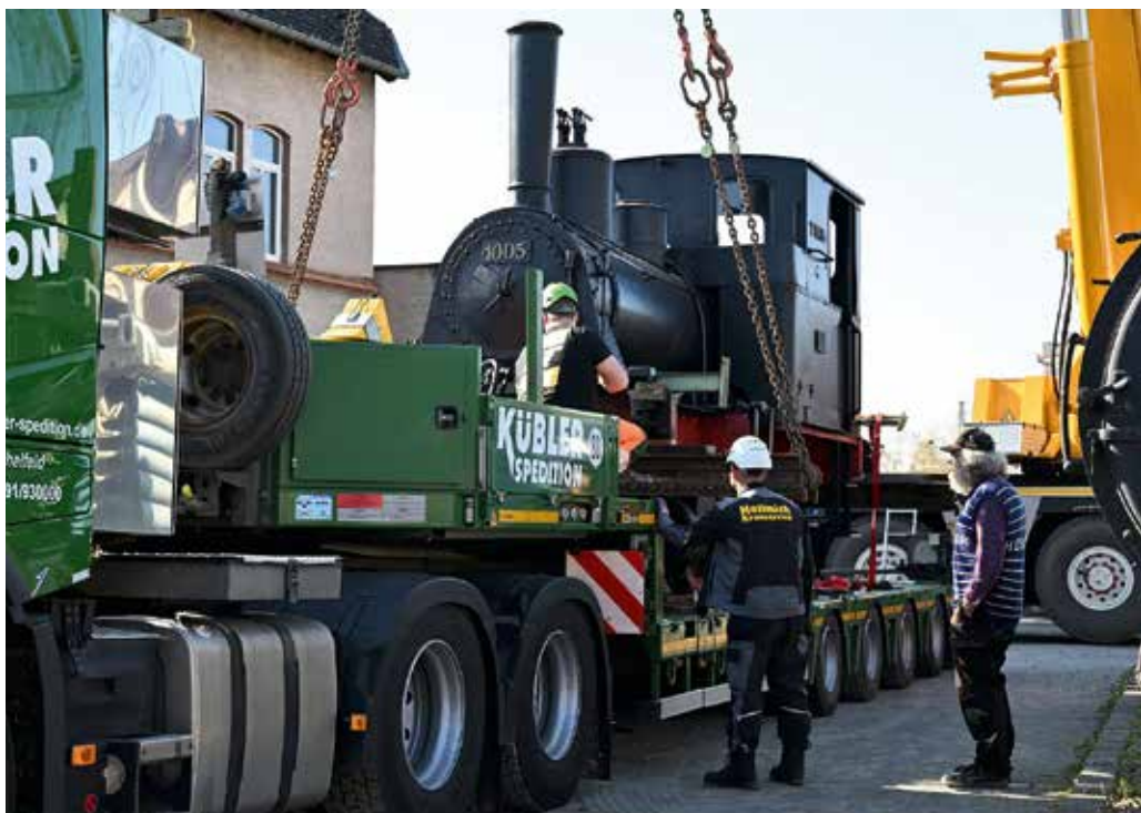
Vorbereitung für den Hub der Lok vom Tieflader.
